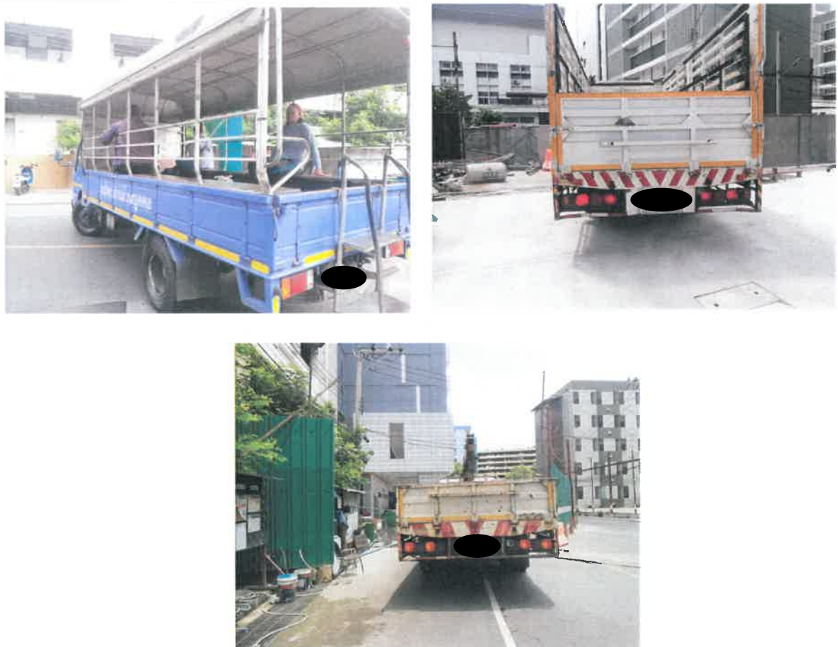
รูปที่ 2-39 แสดงการติดแผ่นป้ายสะท้อนแสงบริเวณด้านท้ายและด้านข้างของรถวัสดุก่อสร้าง
