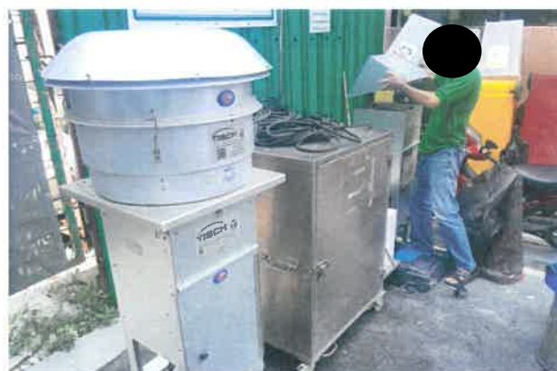
รูปที่ 2-20 แสดงการติดตั้งเครื่องตรวจวัดคุณภาพอากาศ เสียง และความสั่นสะเทือนไว้ในพื้นที่ก่อสร้าง และพื้นที่วิทยาลัยแพทยศาสตร์
